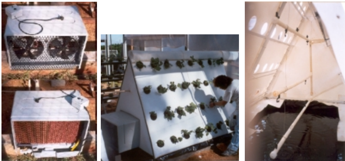
FIGURAS 6,7 e 8 – Resfriador evaporativo; vista geral do sistema; detalhe interno da bancada com os microaspersores.
