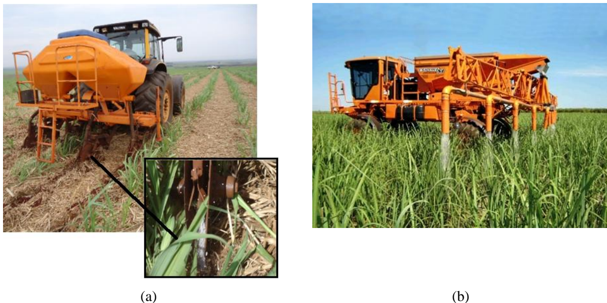
Figura 3 – Exemplo de equipamentos utilizados na adubação em cana-soca. a. Adubadora para aplicação incorporada (DMB, modelo 1250-H, Sertãozinho-SP). B. Equipamento para aplicação em superfície (Jacto, modelo Uniport 3000 NPK, Pompéia- SP)
